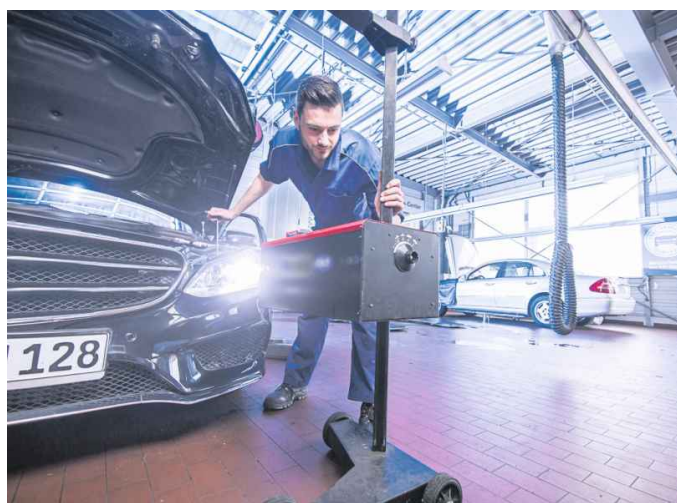
Beim Licht-Test werden neun Beleuchtungspunkte auf Sicht und Funktion sowie die Einstellung aller Lichtsysteme gecheckt. Foto: ProMotor
